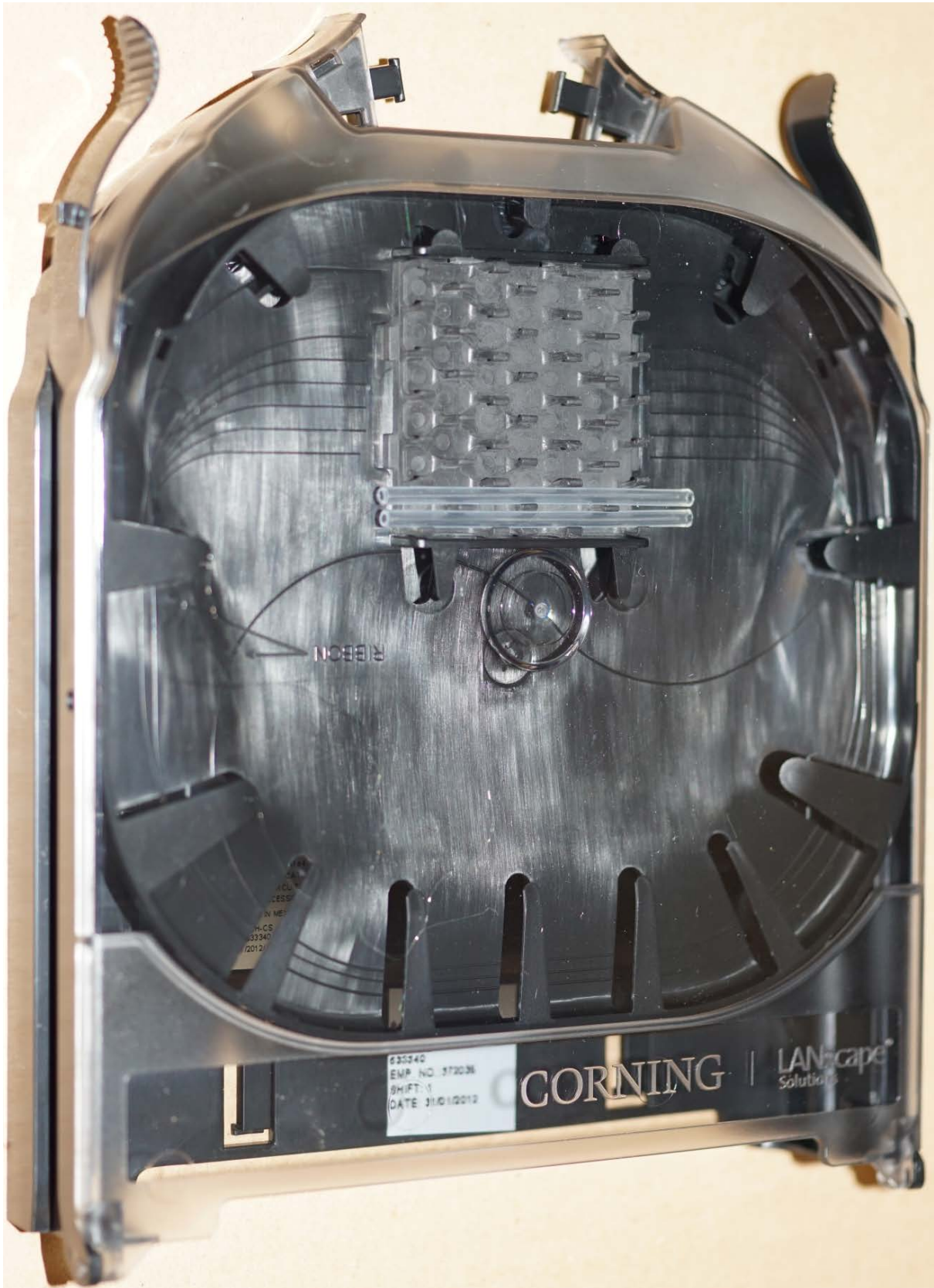
Picture of an actual fiber optic cassette.
